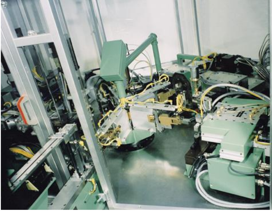
Şekil 3.1 : Döner tabla sistemi ile tasarlanmış şifreleme makinası
