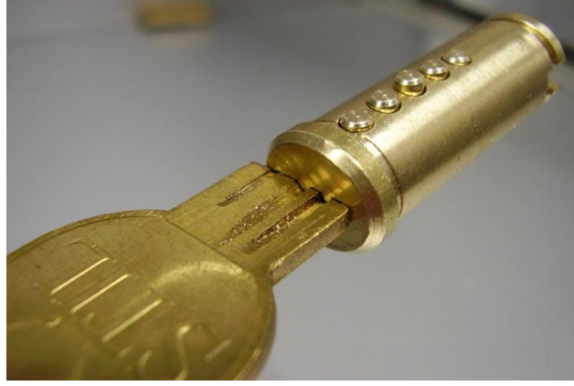
Şekil 2.11 : Yanlış anahtar-şifre pimi eşleşmesi
