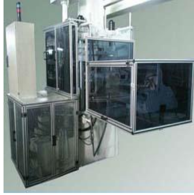
Şekil 3.9 : Sigma profil ile makine kabini uygulaması
