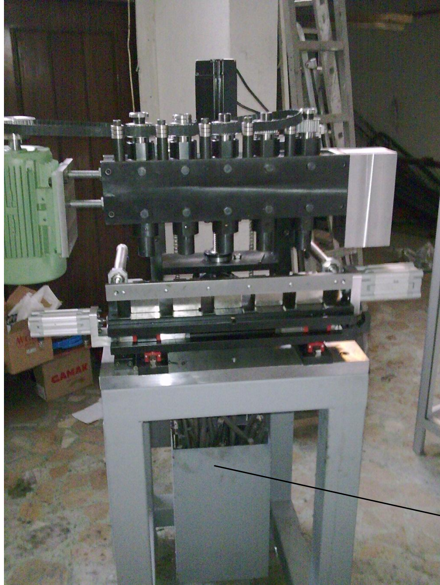
Şekil 3.55 : Doğrusal dengeleme için kullanılan karşı ağırlık
