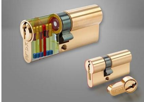
Şekil 2.1 : Bilyalı anahtar kilit sistemi
