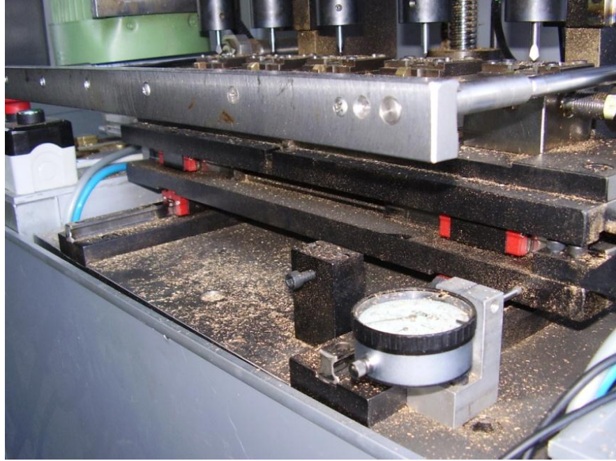
Şekil 3.47 : X-ekseni komparatör bağlantısı
