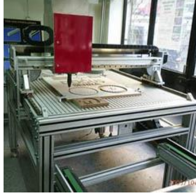
Şekil 3.8 : Sigma profil ile konstrükte edilmiş CNC router
