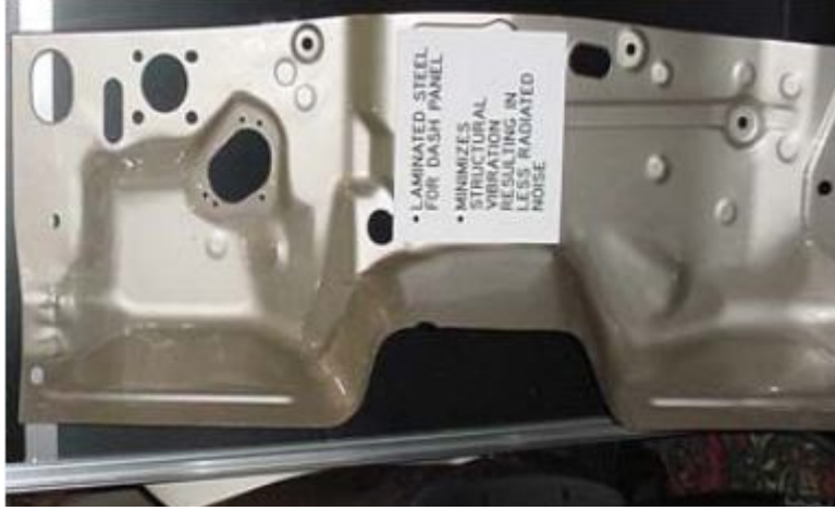
Şekil 1.8 : Ön konsol için viskoelastik malzeme kullanılmış sönümlü panel [2].
