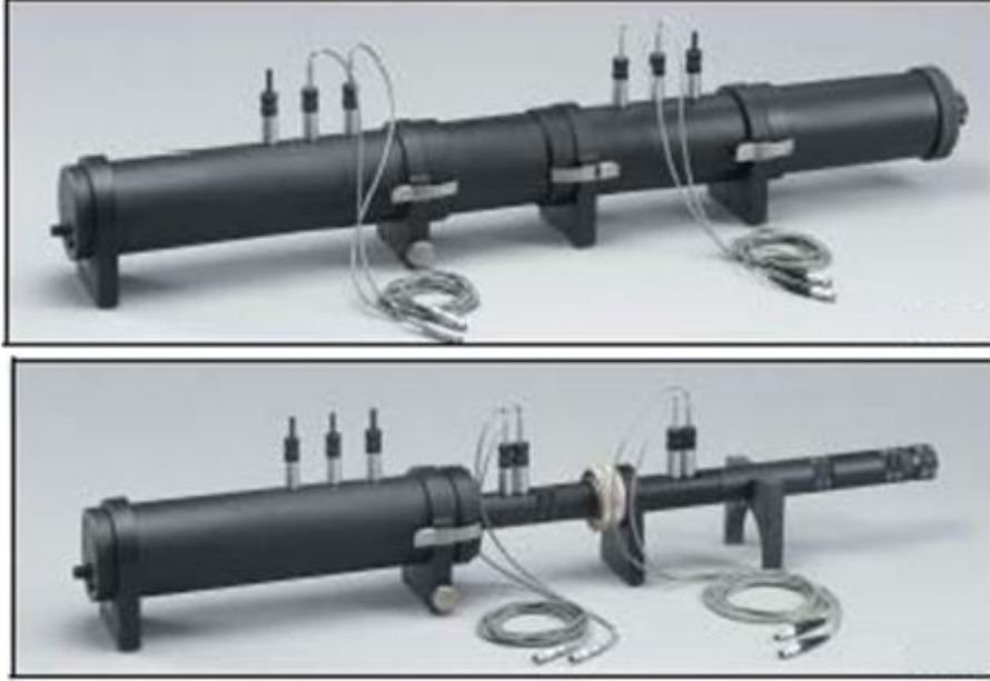
Şekil 4.2 : Ses iletim kaybı ölçümü büyük ve küçük empedans tüpleri [73].
