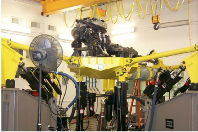
Şekil 2.2 : Titreşimlerin egzoz üzerindeki etkilerini incelediği test düzeneği (Wan ve diğerleri,2001)
