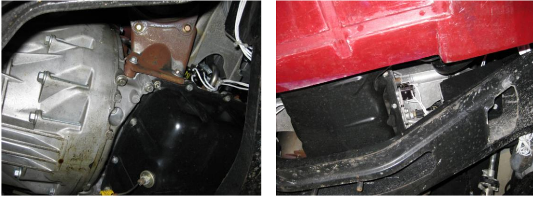
Şekil 6.37 : Motor üzerine yerleştirilen ivmeölçerler.
