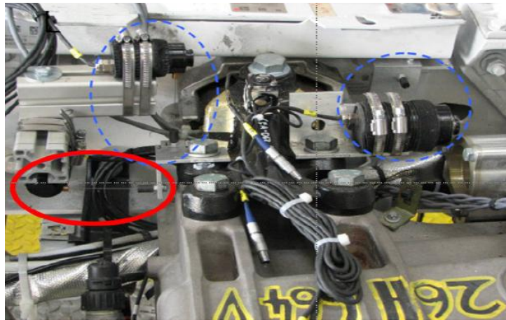
Şekil 6.36 : Bir potansiyometreli deplasman sensörü uygulaması.
