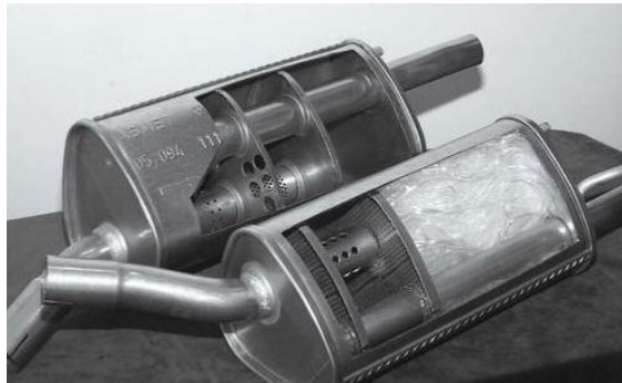
Şekil 1.3 : Yutucu ve yansıtıcı özelliklerin bir arada bulunduğu hibrid tip susturucu.
