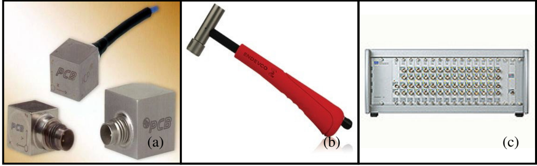
Şekil 4.2: Test Ekipmanları: a) İvmeölçer, b) Modal Çekiç, c) Veri Toplama Cihazı
