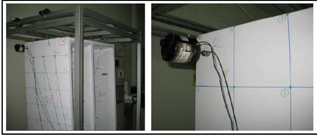
Şekil 5.13: Deneysel Ölçümlerde Kullanılan Sarsıcının Konumu
