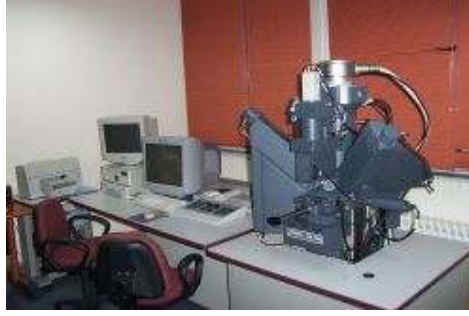
Şekil 6.3 : Elektron MikroProb Analiz (EPMA) Cihazı
