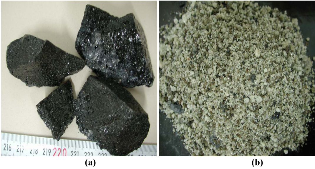
Şekil 2.9 Curuf resimleri (a) havada soğutulmuş (b) hızlı soğutulmuş
