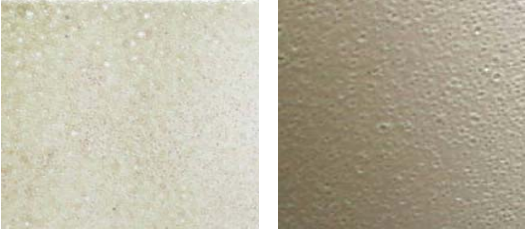
Şekil 5.5. Curuftan gelen emprütelerden dolayı sırda meydana gelen renk oluşumları
