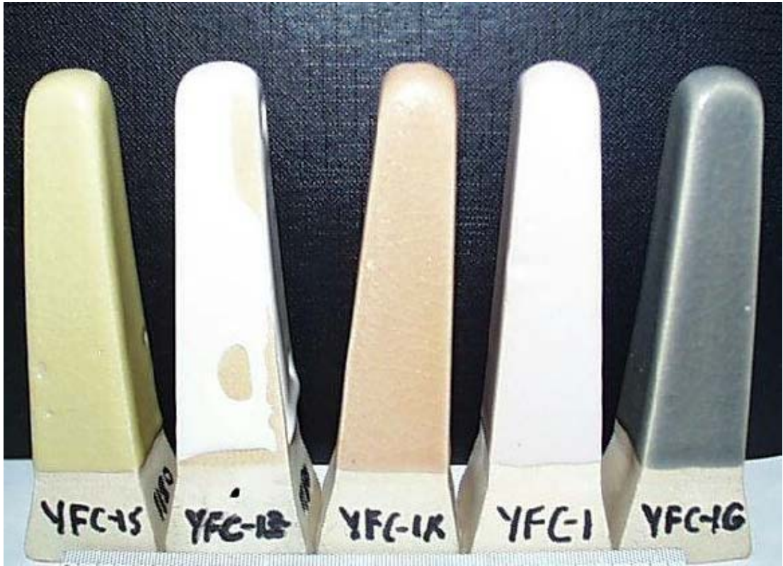
Şekil 5.7. Piramit masseler üzerinde sır deneme çalışmaları.
