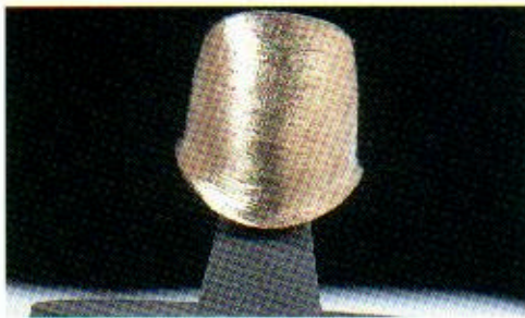
Sekil 8. 8: Dklms metalin kumlama ncesi grnm
