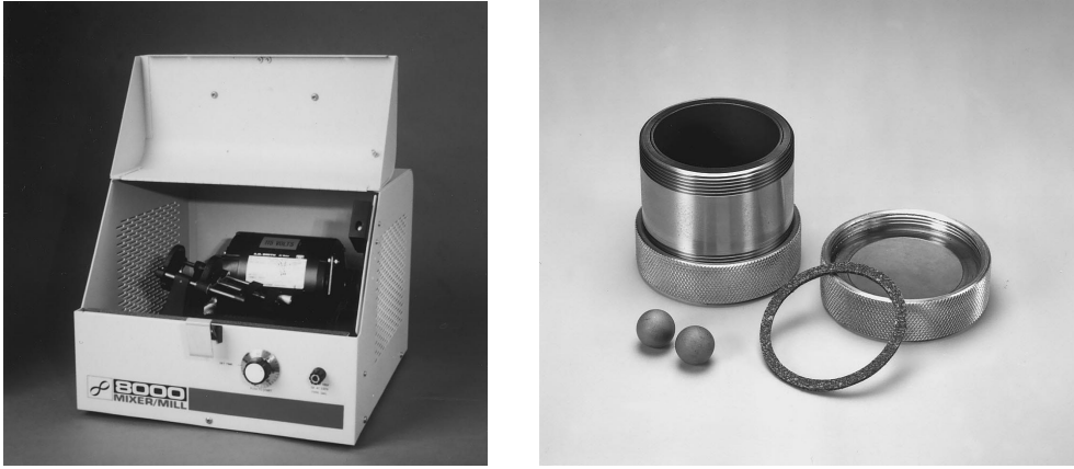
Şekil 3.1 : SPEX 8000 karıştırıcı/öğütücü ve WC kap ve bilyeler [16].
