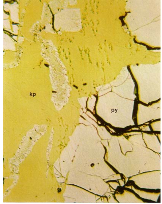
Şekil 4.3: Kalkopirit ( kp ) içerisinde kataklastik yapı gösteren pirit ( py ).
