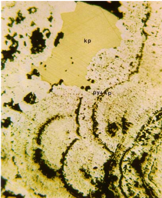
Şekil 4.4: Konsantrik ve koloidal doku da kalkopirit ( kp ) ile birlikte büyüme gösteren pirit ( py ).
