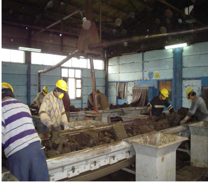
Şekil 3.1 : Elle Ayıklama Tesisi
