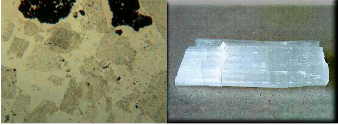
Şekil 1.4 : Kolemanit Parlak Kesit ve Üleksit Makroskopik Örnek
