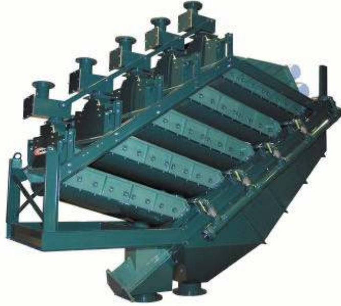
Şekil 3.5 : Çok Katlı Yüksek Frekanslı Elek Sistemi
