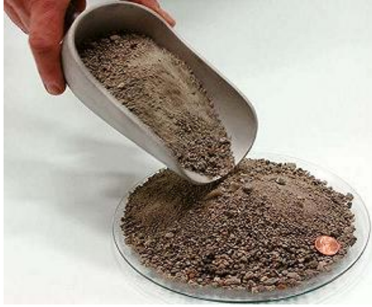
Şekil 4.5: Taban küllerinin genel görünümü [16].
