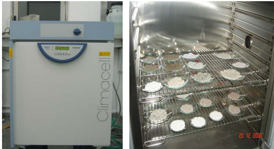
Şekil 5.6 : Deneylerde Kullanılan İklimlendirme Dolabı
