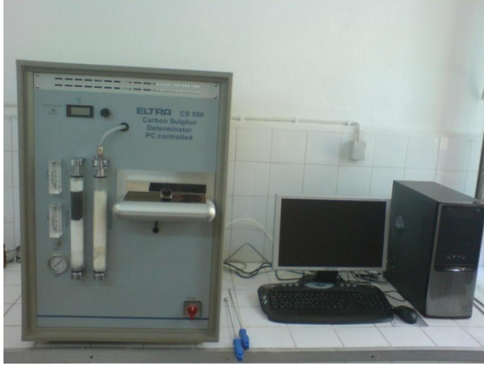
Şekil 3.14 : ELTRA marka C5580 model karbon-kükürt analiz cihazı.
