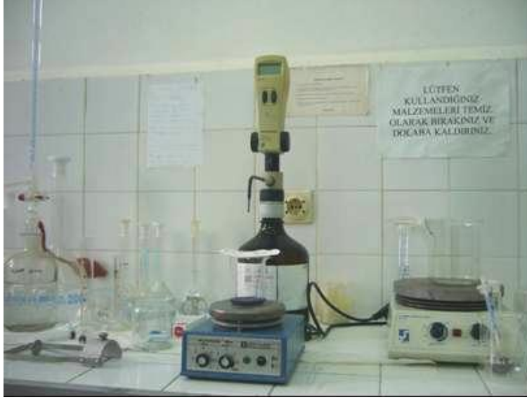
Şekil 3.12 : Kation değişim kapasitesi belirleme düzeneği.
