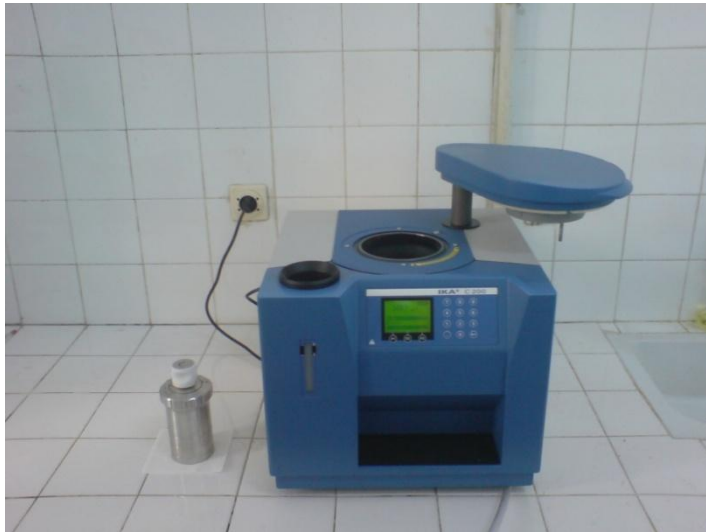
Şekil 3.15 : IKA marka C200 model kalorimetre analiz cihazı.
