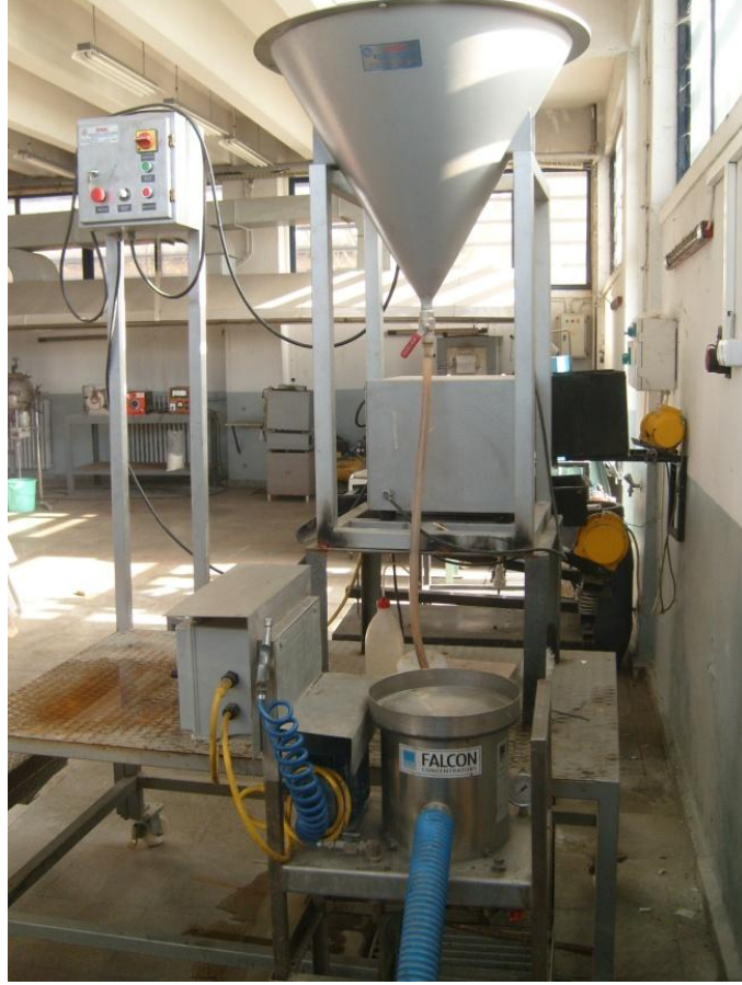
Şekil 3.16 : Laboratuvar ölçekli L40 model Falcon ayırıcısı.
