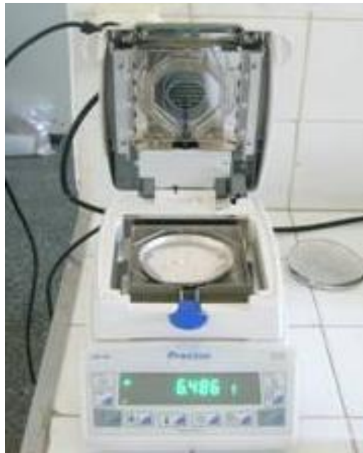
Şekil 3.11 : Precisa halojen kurutucu.
