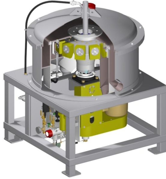
Şekil 2.21 : Falcon C400 ayırıcısı şematik görünümü (Gillis, A., 2011).
