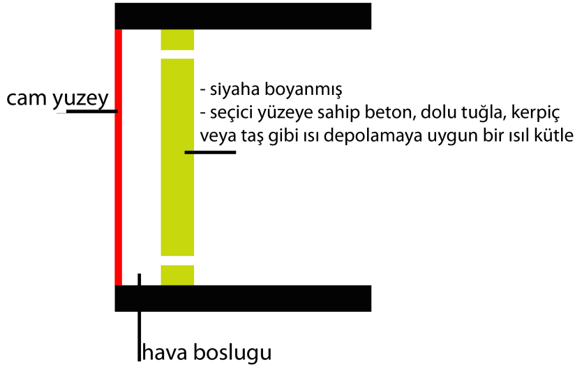
Şekil 5.3 : Trombe duvarı şematik katmanlaşması.
