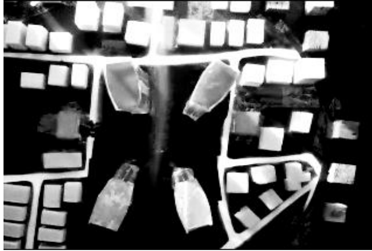
Şekil 6.76 : Rüzgâr tüneli akım görünürleştirme deneyi 4K-SW-PLAN
