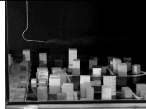
Şekil N.4 : 0K durumunda güneybatı hakim rüzgar yönünde yapılan akım görünürleştirme deneyi- güneydoğu yönünden bakış
