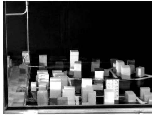
EK N.4 :Duman deneyi sonuçları- güneydoğu yönünden bakış-0K-SW
