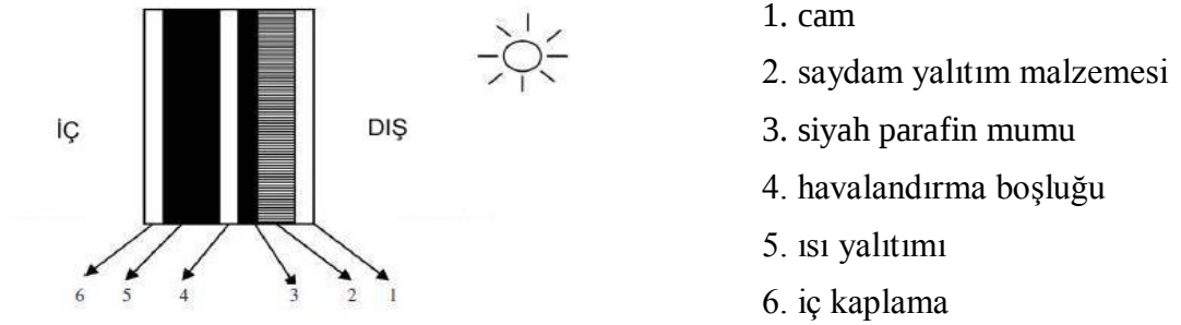
řekil 4.21: Faz Deęiřtiren Malzemeyle Solar Duvar
