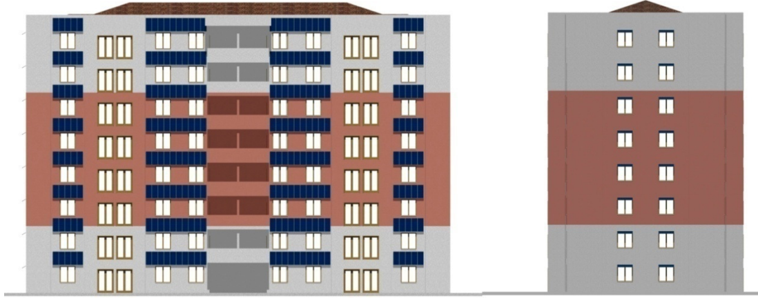
Şekil 5.18 : A blok pv panel yerleşimleri.
