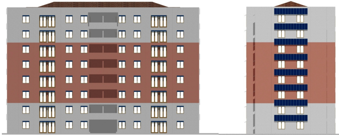
Şekil 5.19 : B blok pv panel yerleşimleri.
