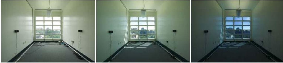
Şekil 3.9 : LBNL tesisinde gelişmiş cephe sistem bileşenlerinden biri olan elektrokromik cam için gerçekleştirilen saha testi.
