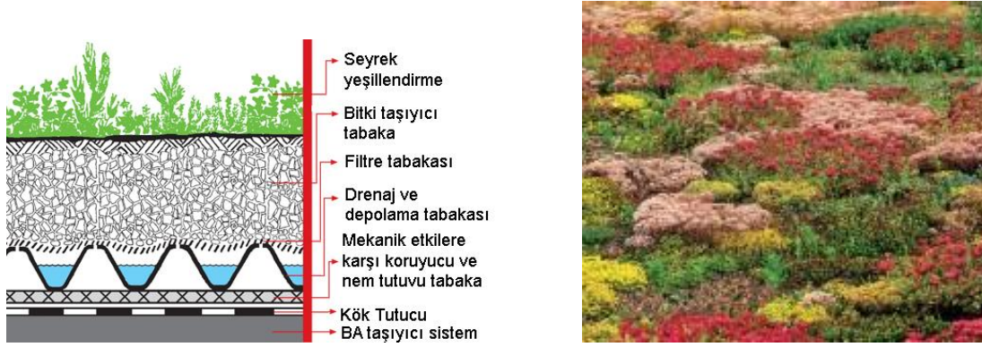
Şekil 3.18 : Seyrek yeşil çatı ve görünüşü.
