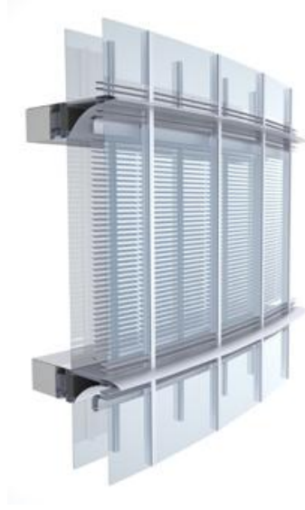
Şekil 3.12 : 1 Bligh Street Binası, Sydney, iki katman arası güneş kontrol bileşeni kesit-perspektifi.
