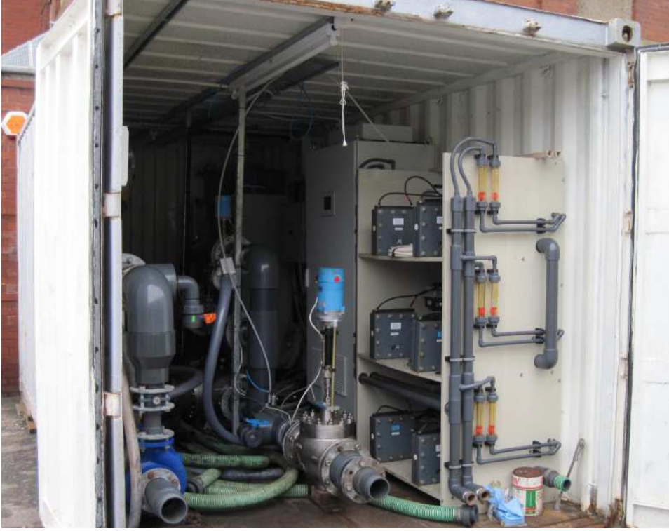
Şekil 6.70 : BaWaPla Pilot Sistemi: Filtre-UV-Elektrokimyasal Sistem, Blyth, Ağustos 2009.
