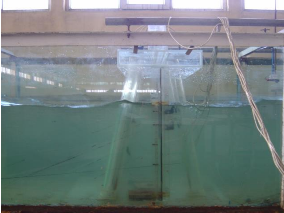
Şekil 4.38: Konfigürasyon 5 için kazıklı dalgakıranın görünüşü.
