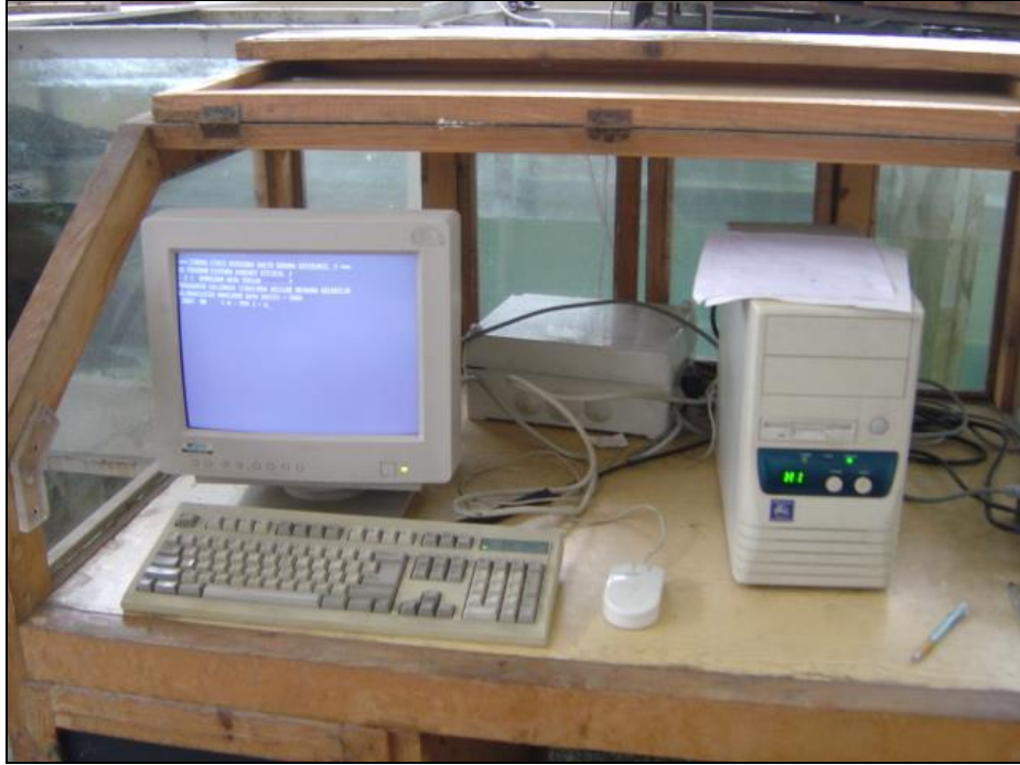
Şekil 3.4: Dalga üretici bilgisayar ile kontrol ünitesinin görünüşü.
