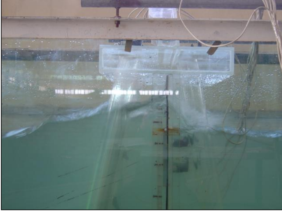
Şekil 4.48: Konfigürasyon 6 için kazıklı dalgakıranın görünüşü.
