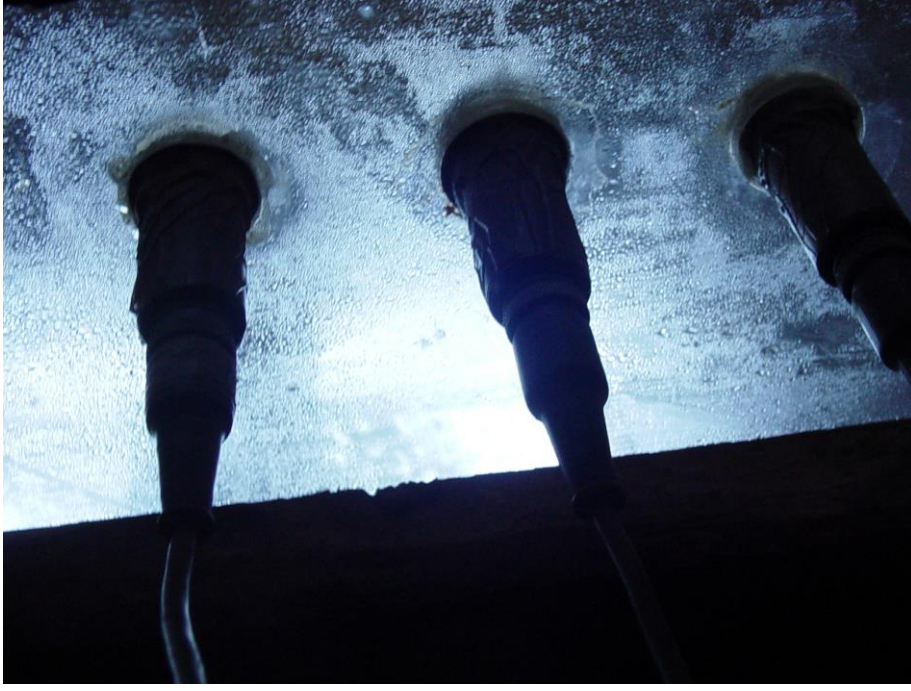
Şekil 3.6 Kanalin Alt Kısımından Pleksiglasa Monte Edilen Basınç Ölçerlerin Alttan Görünüşü
