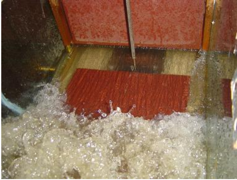
Şekil 3.11 Hidrolik Sıçramayı Oluşturan Deney Kapağından Sonraki İlk Basınçölçer Üzerinde Oluşan Sıçrama
