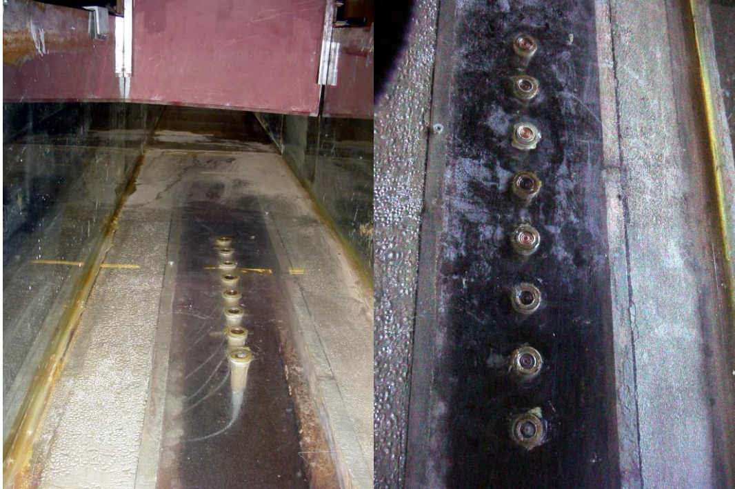
Şekil 3.5 Tabanda, Pleksiglas Levha Üzerine Monte Edilen Basınç Dönüştürücülerinin Görünüşü
