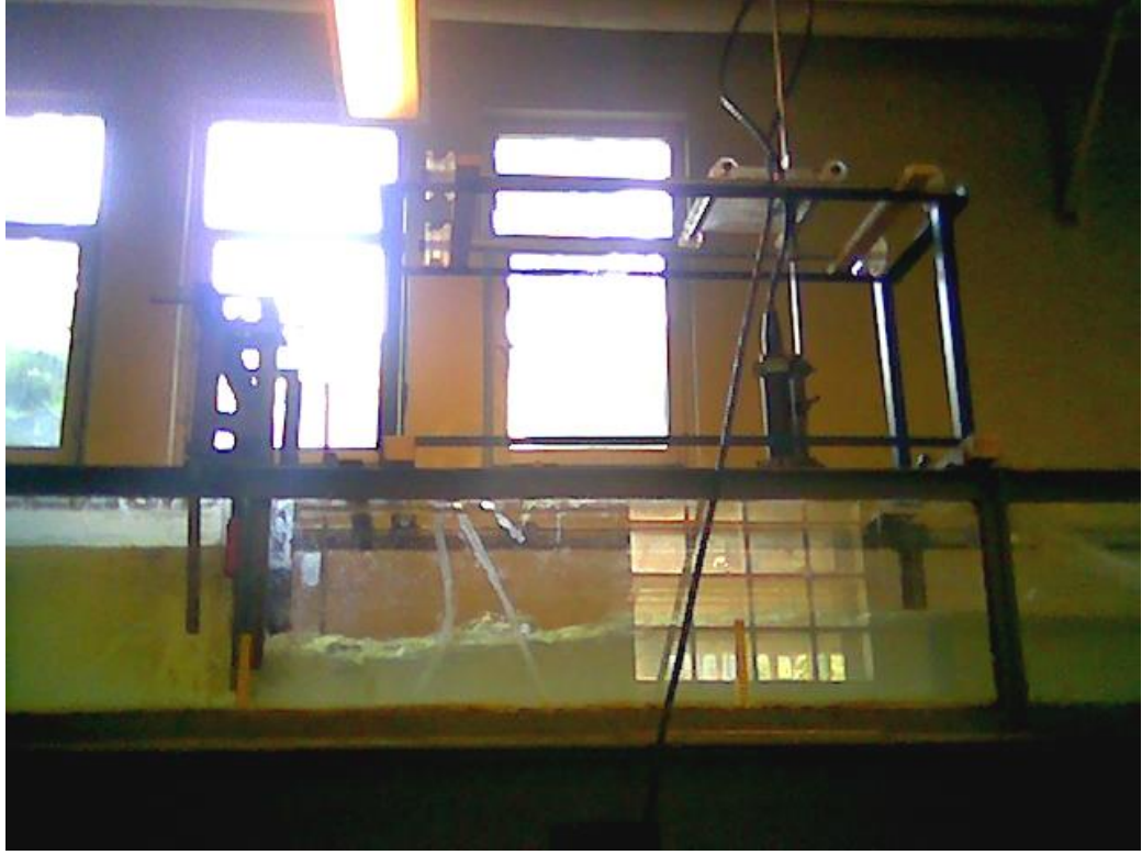
Şekil 3.3 Deney Kapağının ve Hız Ölçüm Düzenekinin (ADV) Görünüşü
