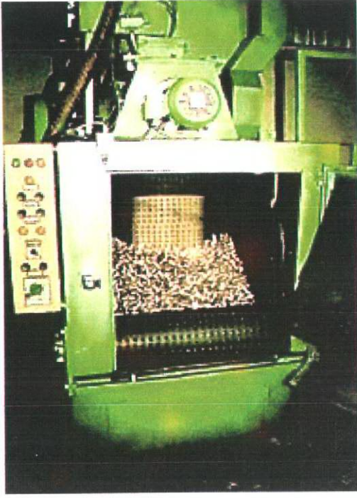
Şekil 1.14: Kumlanmış pirinç boru dirsekleri ile bir tamburlu kumlama makinası
