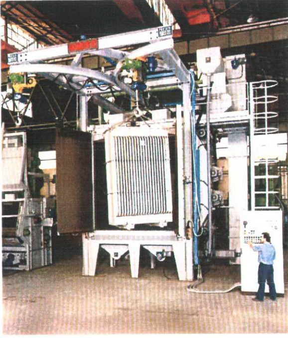
Şekil 1.16: Otomatik kancalı askılı tip bir kumlama makinası
