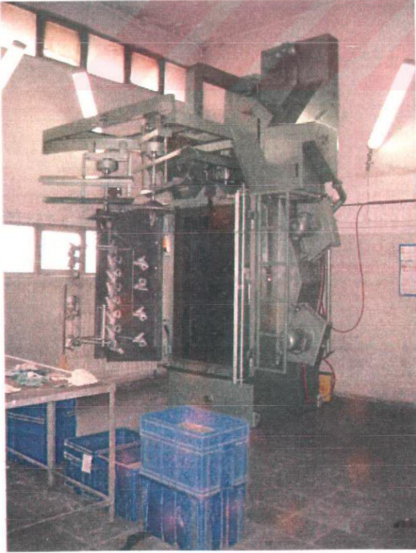
Şekil 1.15: 1200x1700 mm ağız açıklığı olan askılı tip bir kumlama makinası
