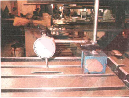
Şekil 5.3: Test şeritlerinin eğrilik yüksekliğinin komparator yardımıyla okunması
