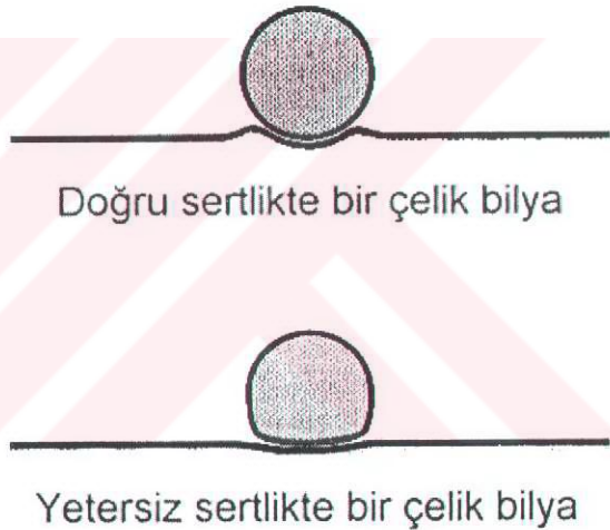
Şekil 3.1: Bilya ve kumlanan parça arasındaki sertlik ilişkisi
