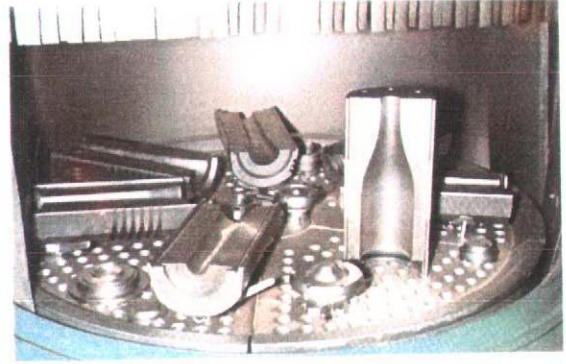
Şekil 2.2: Cam kalıplarının kumlanarak temizlenmesi
