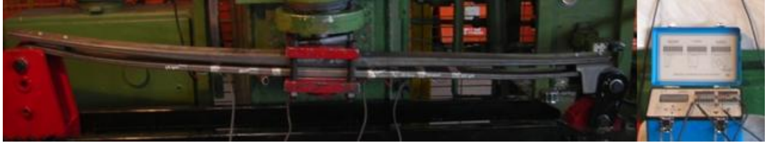
Şekil 6.9 : En büyük yükte gerinim ölçümü.
