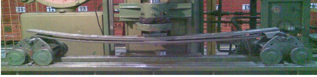
Şekil 6.2 : Test makinesinde serbest halde yay katsayısı ölçümü.
