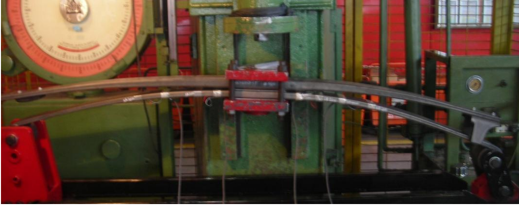
Şekil 6.7 : Yaprak yayın araca bağlantı konumunda donanım üzerinde test makinasında görünümü.
