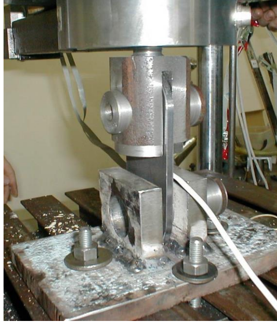
Şekil 7.6 Baklanın test makinasına bağlanmış hali
