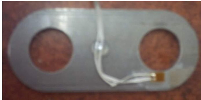
Şekil 7.5 Strain gage’in zincir baklası üzerine yapıştırılmış durumu
