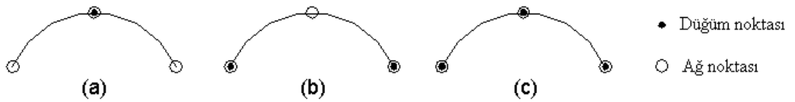
Şekil 6.22 İki boyutlu problemlerde kullanılan eleman tipleri a) Sabit b) Doğrusal c) Kuadratik
