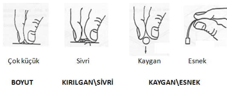
Şekil 2.1 : Parçanın yüzey ve geometrik özelliklerine dair sınıflandırma örneği [7]
