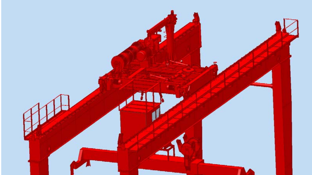
Şekil 7.12 : Yürüme yolu ve bakım platformu.
