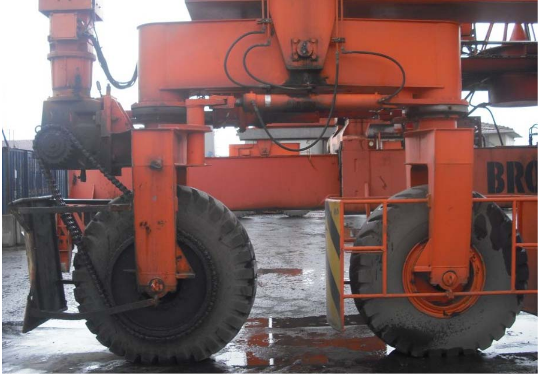
Şekil A.2 : Yürütme grubu zincirli tahrik görünümü.
