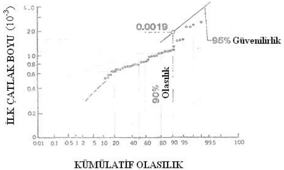
Şekil 5.6. Düz Delik Etrafında İlk Çatlak Boyu ve Güvenilirlik
