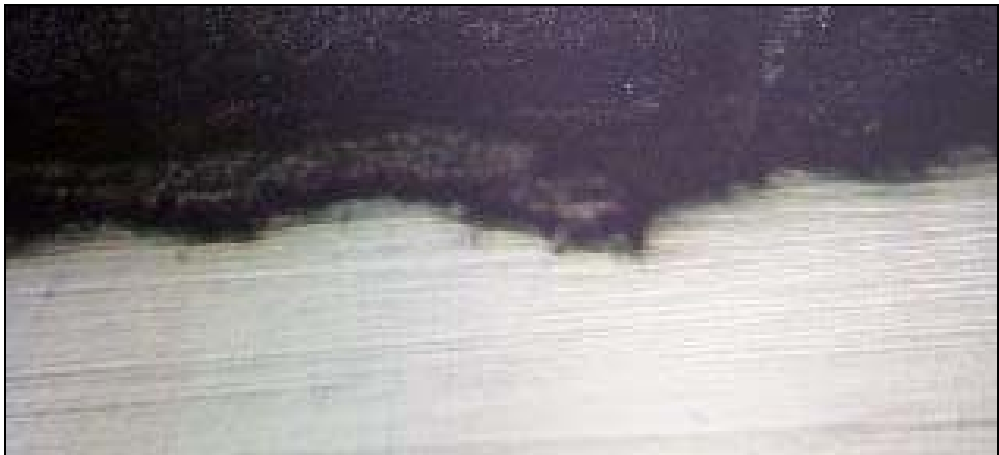
Şekil 5.13 1000 °C'de tufal tabakası oluşumunun malzeme yüzeyine etkisi (100X)
