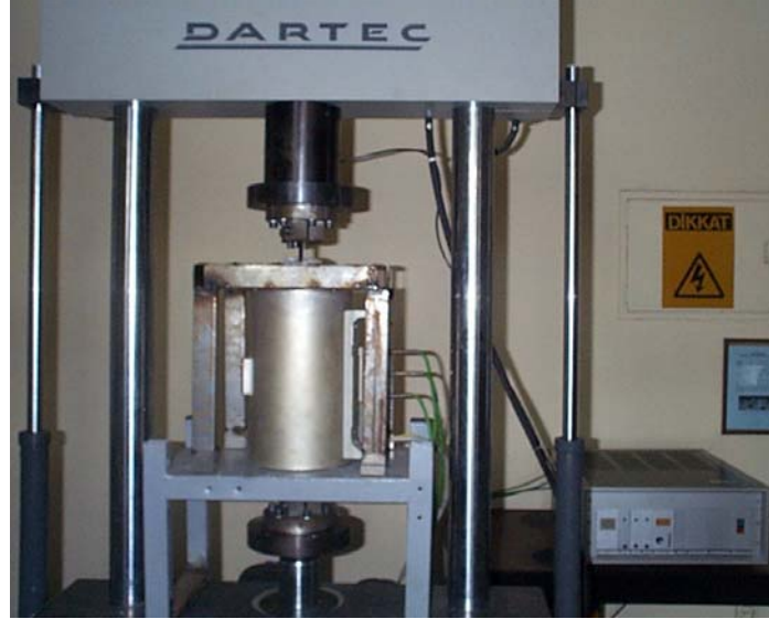
Şekil 4.4 Yarı-sıcak/sıcak çekme deneylerinde kullanılan çekme cihazı ve sıcaklık kontrol cihazı
