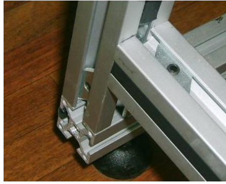
Şekil 7.22 : Çağlık Profilleri Montajı
