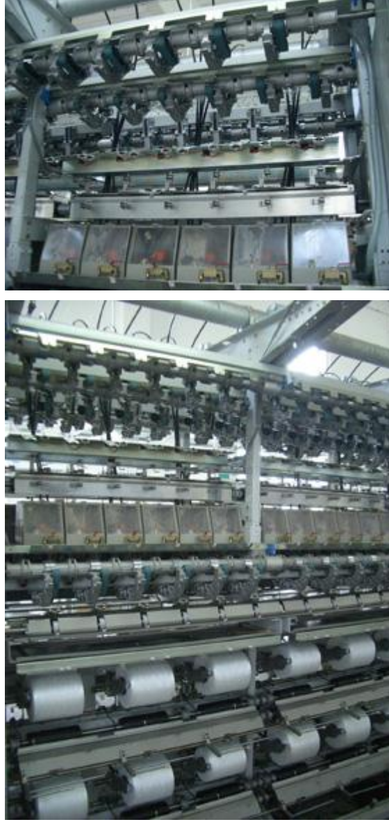
Şekil 3.11 : Aiki Riotech At 501C Hava Jeti İle Tekstüre Makinası [30]
