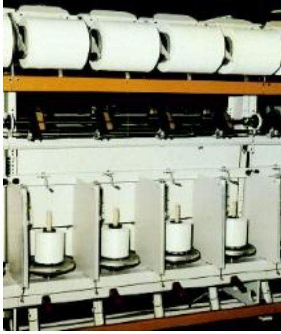
Şekil 4.14 : Rieter Dt 326 E Tfo Makinası [35]
