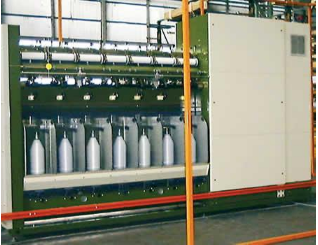
Şekil 4.4 : Ratti R325 LN Tfo Makinası [36]
