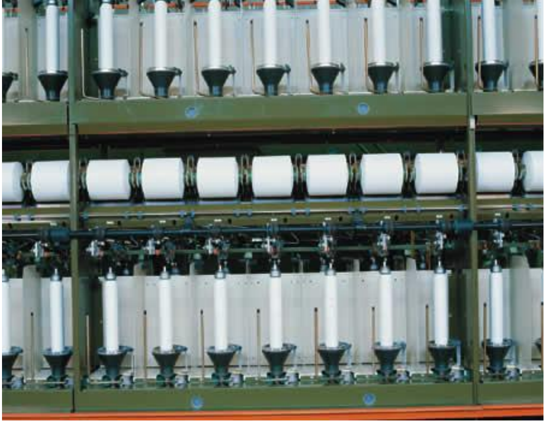
Şekil 4.8 : Ratti R326 N Tfo Makinası [36]
