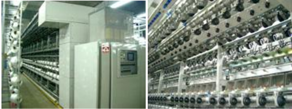
Şekil 3.10 : Aiki Riotech At 501A Hava Jeti İle Tekstüre Makinası [28]
