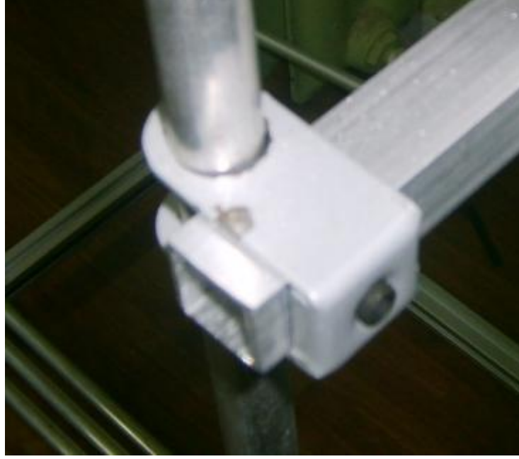
Şekil 7.30 : Boruların Bağlama Elemanları İle Sabitlenmesi
