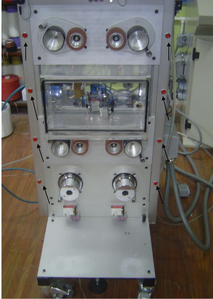
Şekil 8.8 : Acil Dur Butonlarının Makina Üzerine Yerleşimi
