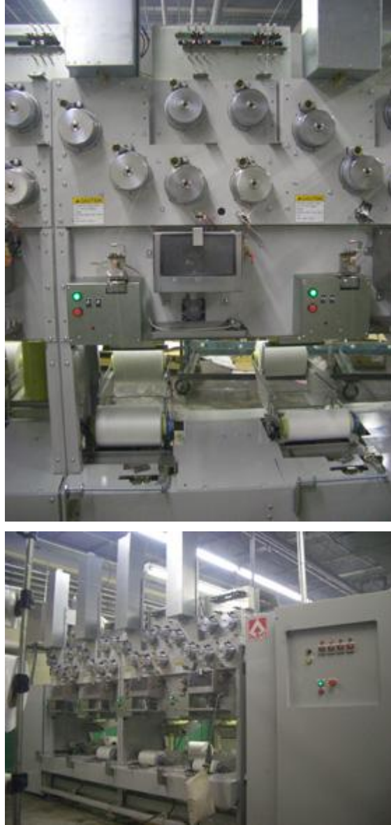
Şekil 3.14 : Aiki Riotech At 501HD 900 Hava Jeti İle Tekstüre Makinası [33]
