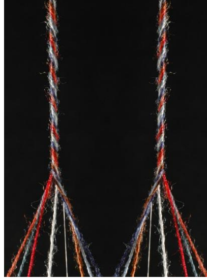
Şekil 4.24 : Bir Tuş İle S ve Z Bükümlerinden Diğesine Geçilebilmektedir [22]
