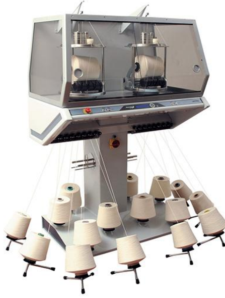
Şekil 4.22 : 8 Kat İpliğe Kadar İplik Katlaması İmkânı Veren Besleme Bobini Dizilimi [22]
