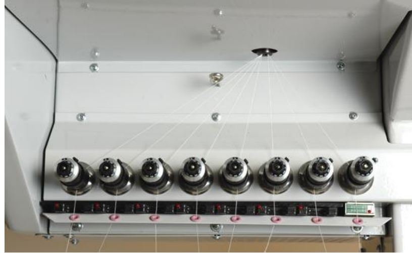
Şekil 4.21 : İplik Rehberleri Ve İplik Gerginlik Ayarlayıcılar [22]
