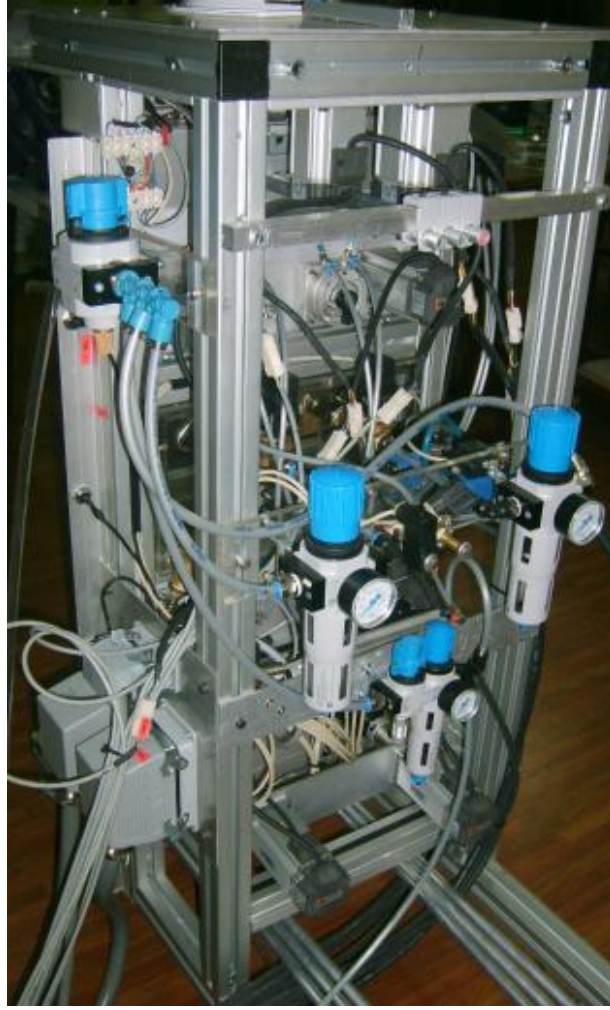
Şekil 7.20 : Pnömatik Elemanların Makine Üzerindeki Genel Yerleşimi
