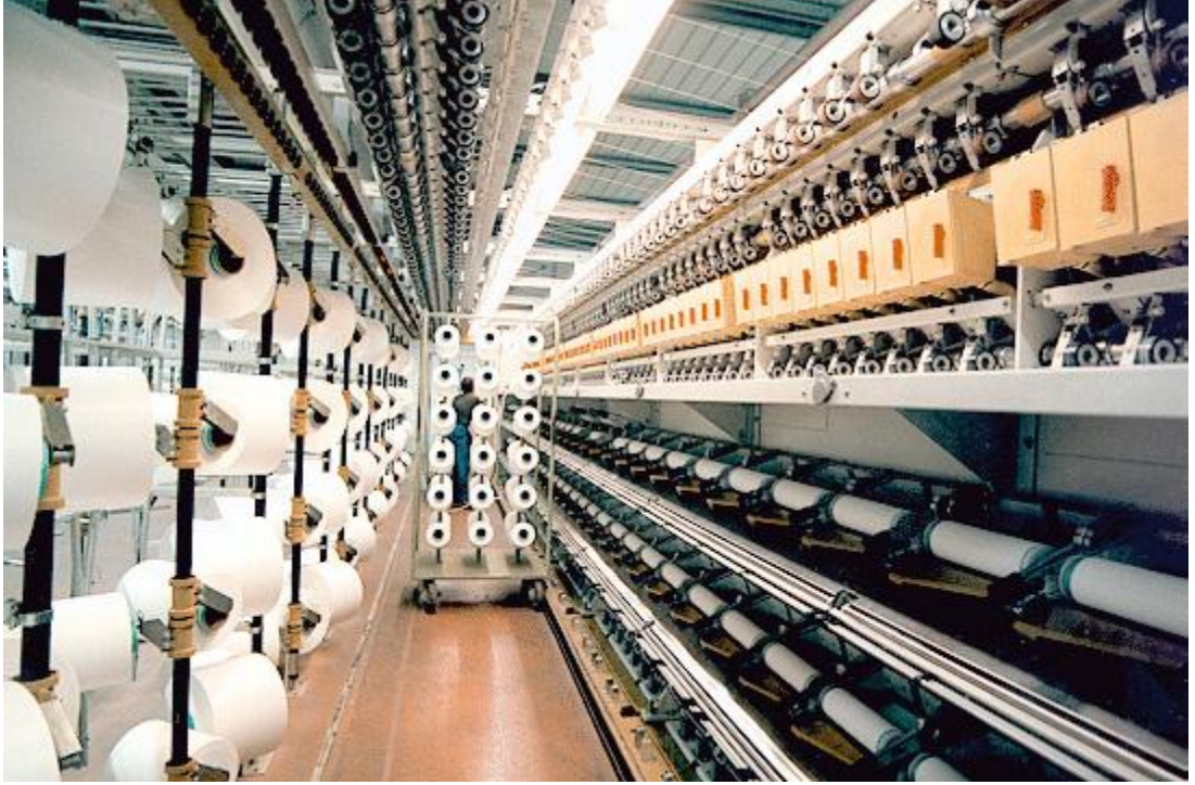
Şekil 3.16 : Rieter At8 E2 Hava Jeti İle Tekstüre Makinası [35]
