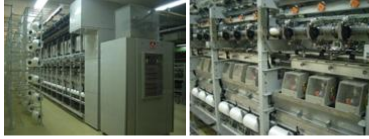
Şekil 3.12 : Aiki Riotech At 501EXII Hava Jeti İle Tekstüre Makinası [31]
