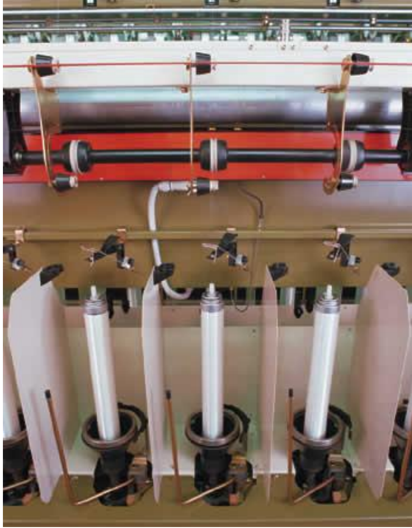
Şekil 4.7 : Ratti R325 N/F Tfo Makinası [36]
