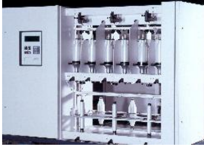
Şekil 4.16 : Rieter Dtar 368 E Tfo Makinası [35]
