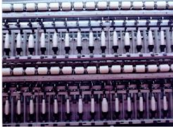
Şekil 4.15 : Rieter Dt 362 Hp Tfo Makinası [35]
