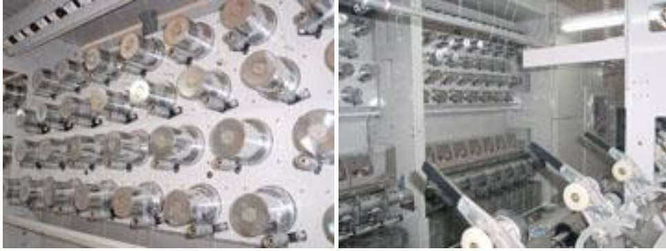
Şekil 3.13 : Aiki Riotech At 501MD Hava Jeti İle Tekstüre Makinası [32]
