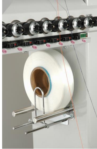
Şekil 4.23 : Seçime Bağlı Lycra Besleme Bobini Konumu [22]
