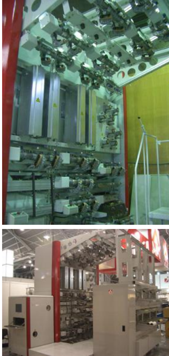
Şekil 3.15 : Aiki Riotech VT-6 Hava Jeti İle Tekstüre Makinası [34]
