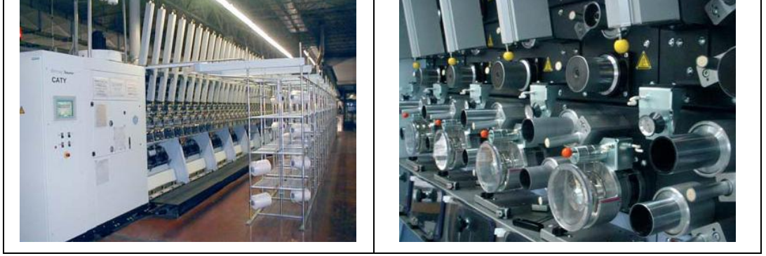
Şekil 3.2 : Barmag Caty Hava Jeti İle Tekstüre Makinesi [25]
