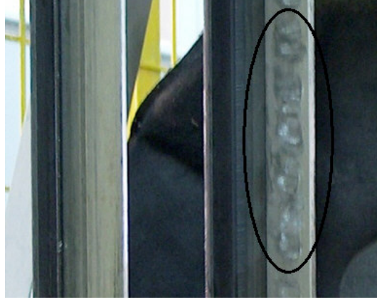
Şekil 8.32 : Gerçek blokta meydana gelen deformasyonlar
