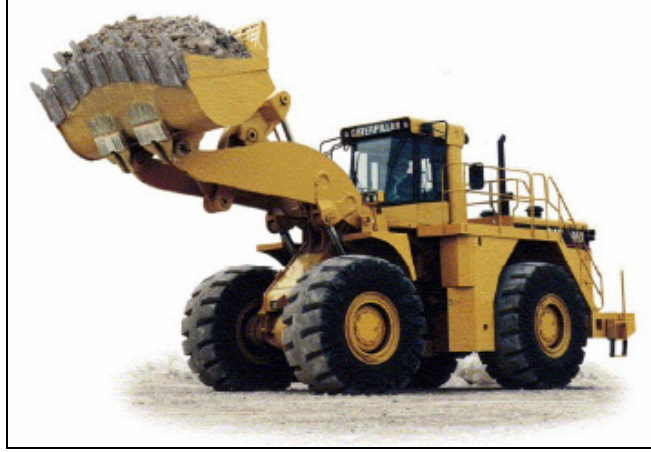
Şekil 3.4-A Tipik Tekerlekli Tip Belden Kırma Dümenlemeye Sahip Ön Yükleyici[10]
