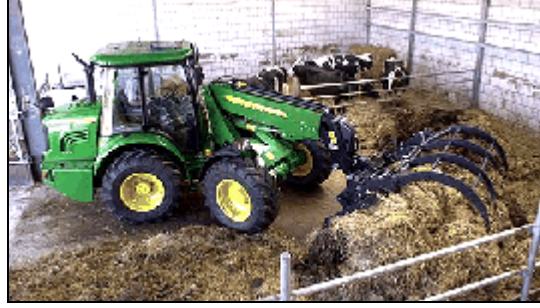
Şekil 3.4-B Belden Kırma Dümenlemeli Traktörün Çiftliklerdeki Uygulaması[11]
