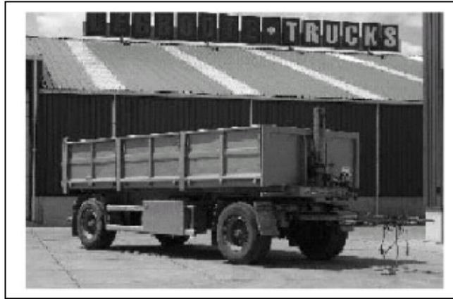
Şekil 1.7 Dingil Dönüslü Mekanizmalı Taşıt Örneği[1]
