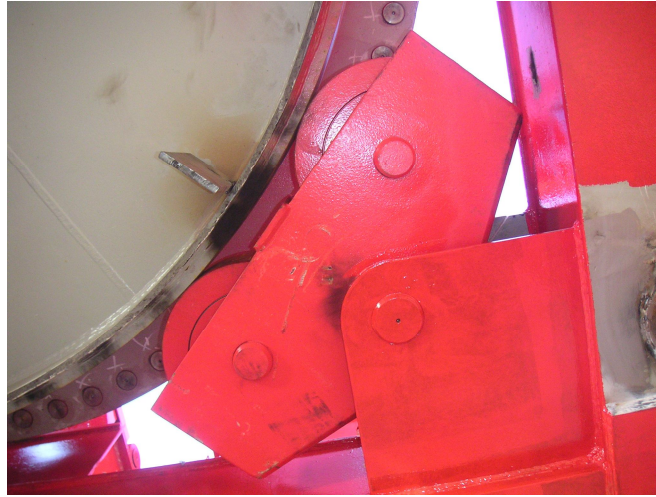
Şekil 2.6: Dönüş Bojisi ve Ø400mm Tekerlekler
