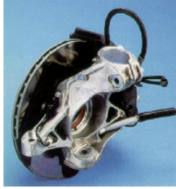
Şekil 6.9 Yüksek oranda alüminyum kullanılmış bir fren sistemi [17]
