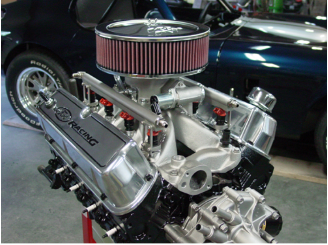
Şekil 6.5 Yüksek oranda alüminyum kullanılarak üretilmiş yüksek performanslı bir motor [17]
