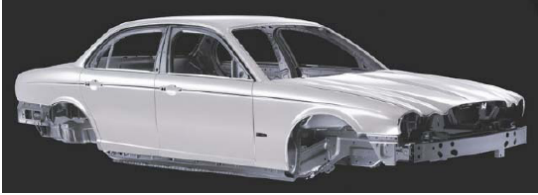
Şekil 6.15 Örnek bir alüminyum gövde [14]
