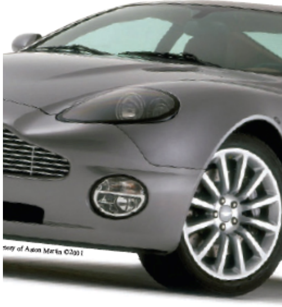
Şekil 6.12 Alüminyum döküm yöntemiyle üretilmiş bir otomobil jantı [17]
