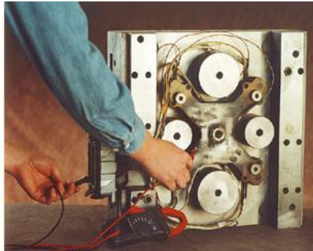
Şekil 4.6: Sıcak yolluklu bir kalıp tasarımı
