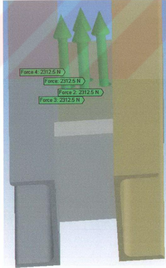
Şekil 6.7 Üst askı kirişindeki yüklerin modele uygulanması
