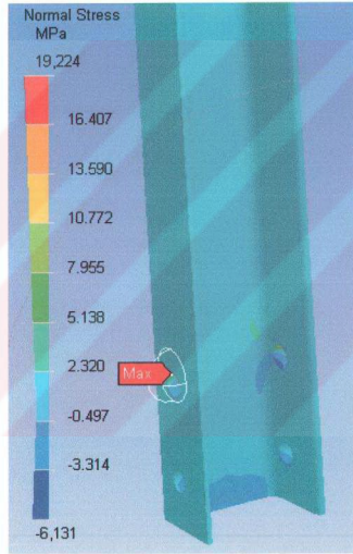
Şekil 6.23 Yan kirişteki gerilme analizi değerleri
