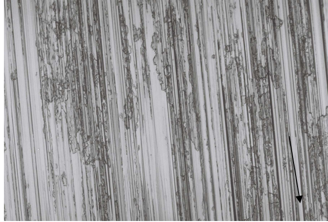
Şekil B.14: PET, aksel R_a = 0.3 \mu\text{m} için deney öncesi (a) ve deney sonrası (b) disk yüzeyinin optik mikro fotoğrafı
