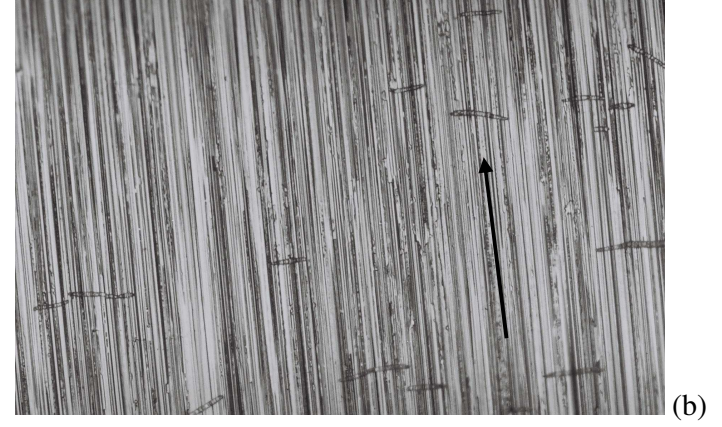
Şekil B.24: a) PET ile çalışmış eksenel R_a değeri 0.7 \mu\text{m} olan disk yüzeyinde, deney sonrası aşınma döküntülerinin optik mikro fotoğrafı b) PP ile çalışmış eksenel R_a değeri 0.3 \mu\text{m} olan disk yüzeyinde, deney sonrası aşınma döküntülerinin optik mikro fotoğrafı
