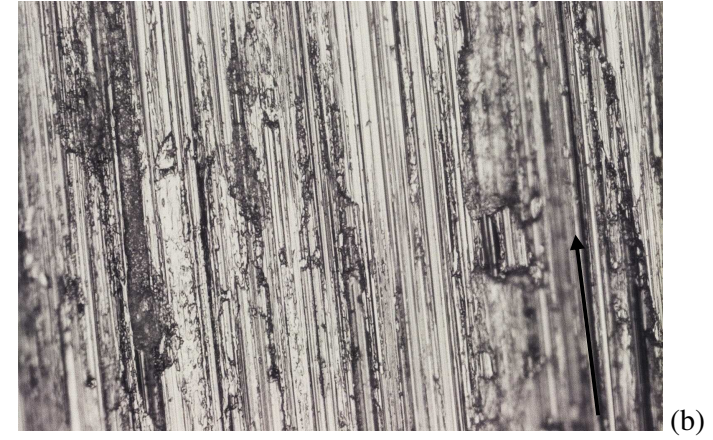
Şekil B.16: PET, eksenel R_a = 2.86 \mu\text{m} için deney öncesi (a) ve deney sonrası (b) disk yüzeyinin optik mikro fotoğrafı
