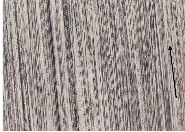
Şekil B.7: Döküm PA6, eksenel R_a = 0.1 \mu\text{m} için deney öncesi (a) ve deney sonrası (b) disk yüzeyinin optik mikro fotoğrafı
