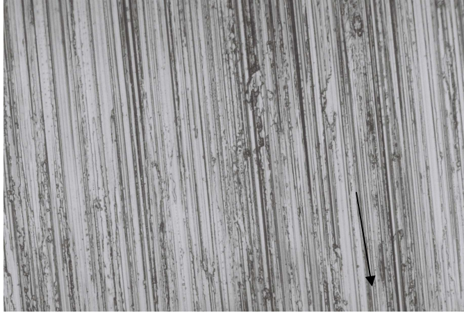
Şekil B.14: PET, aksel R_a = 0.3 \mu\text{m} için deney öncesi (a) ve deney sonrası (b) disk yüzeyinin optik mikro fotoğrafı
