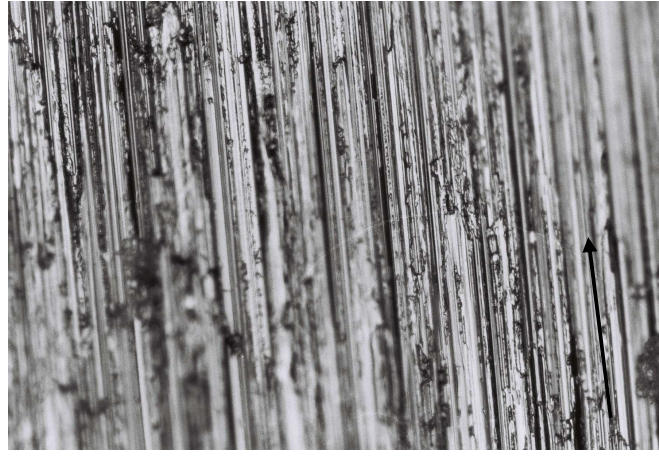
Şekil B.21: POM, eksenel R_a = 3.14 \mu\text{m} için deney öncesi (a) ve deney sonrası (b) disk yüzeyinin optik mikro fotoğrafı
