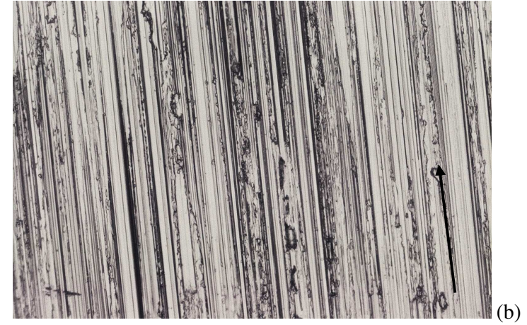
Şekil B.18: POM, eksenel R_a = 0.70 \mu\text{m} için deney öncesi (a) ve deney sonrası (b) disk yüzeyinin optik mikro fotoğrafı
