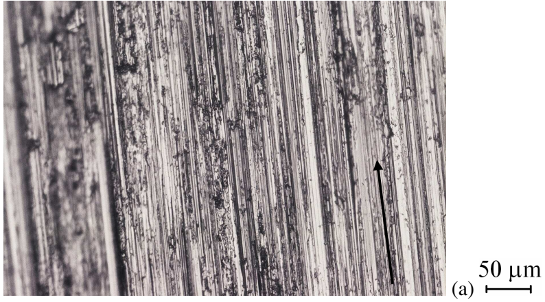
Şekil B.16: PET, eksenel R_a = 2.86 \mu\text{m} için deney öncesi (a) ve deney sonrası (b) disk yüzeyinin optik mikro fotoğrafı
