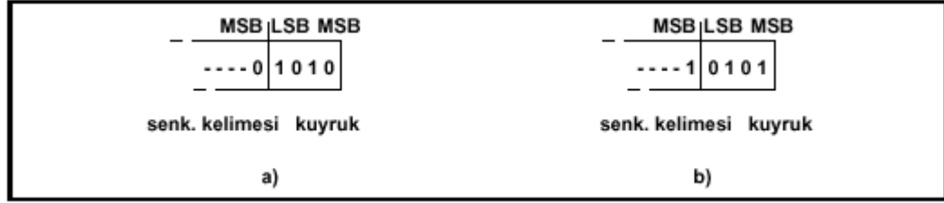
Şekil 4.9 CAC daki kuyruk (trailer). Senkronizasyon sözcüğünün MSB si 0 iken (a), ve 1 iken (b).
