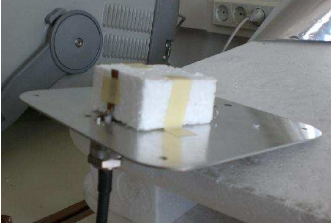
Şekil 6.1: Kullanılan monopol anten yapısı
