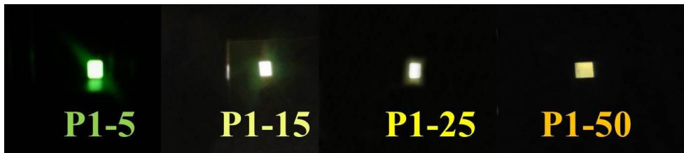
Şekil 4.34 : P1 diyotlarının potansiyel altındaki görünümüleri.
