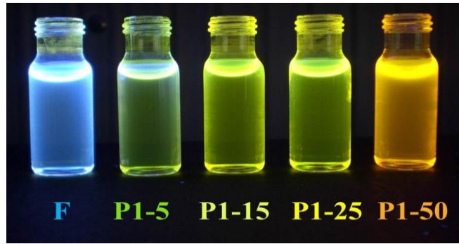
Şekil 4.14 : F ve P1'lerin THF çözeltilerinin UV lambası altındaki görünümü.
