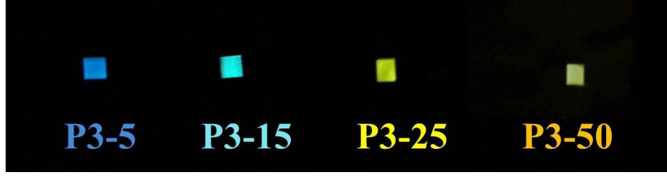
Şekil 4.44 : P3 diyotlarının potansiyel altındaki görünüşleri.
