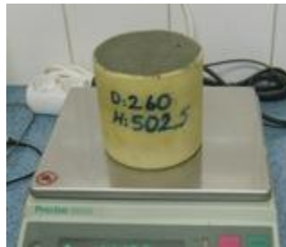
Şekil 3.4.3.2: Çimentonun birim ağırlığının bulunması.
