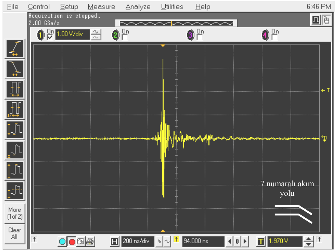
Şekil C.7. 7 numaralı akım yolunda meydana gelen boşalmanın oluşturduğu girişim
