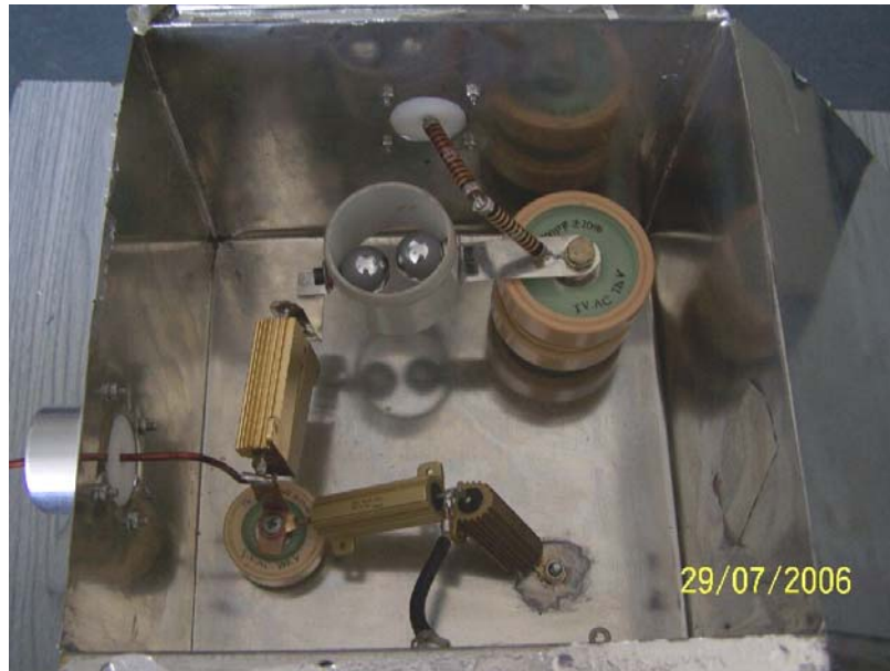
Şekil 3.7. Gerçeklenen üreticinin iç devresi
