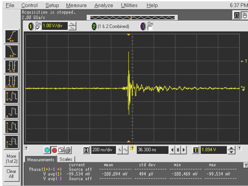
Şekil 5.20. 3 numaralı elektrot sisteminin tek başına oluşturduğu girişim
