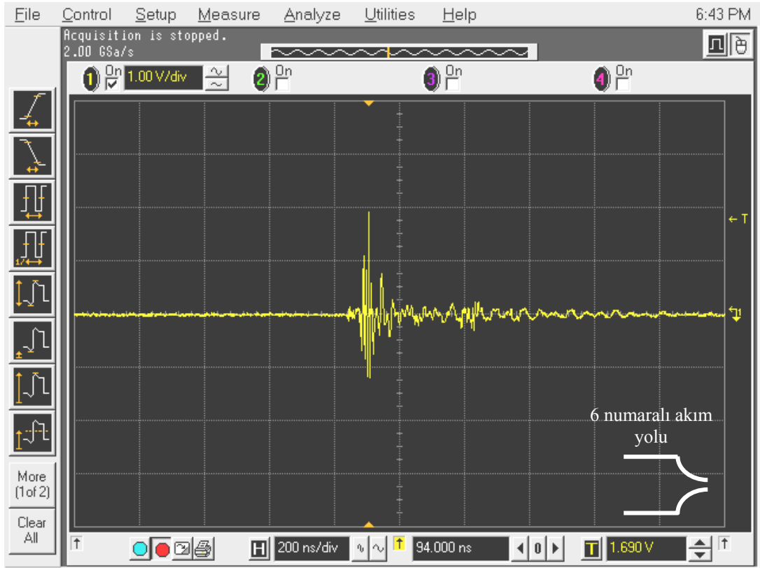
Şekil C.6. 6 numaralı akım yolunda meydana gelen boşalmanın oluşturduğu girişim
