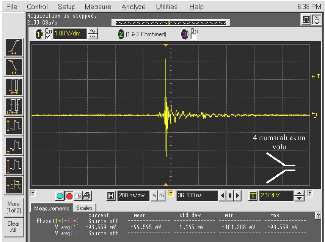
Şekil C.4. 4 numaralı akım yolunda meydana gelen boşalmanın oluşturduğu girişim
