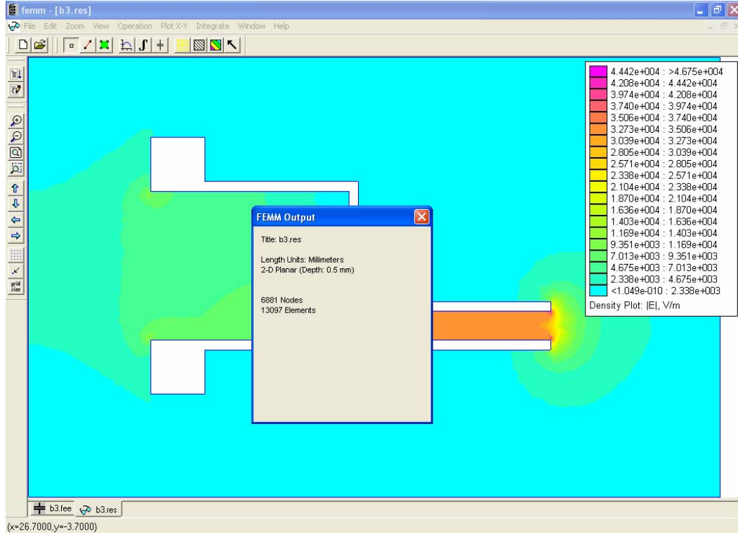
Şekil 6.10. Bir akım yolu şekli için sonlu elemanlar yöntemi ile çözümde kullanılan düğüm ve eleman sayısı.
