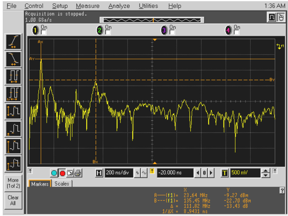
Şekil 5.25. Kabloya kuple olan işaretin frekans bölgesindeki görüntüsü
