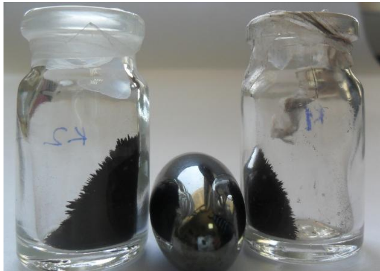
Şekil 3.3: Partiküllerin mıknatısla etkileşimi
