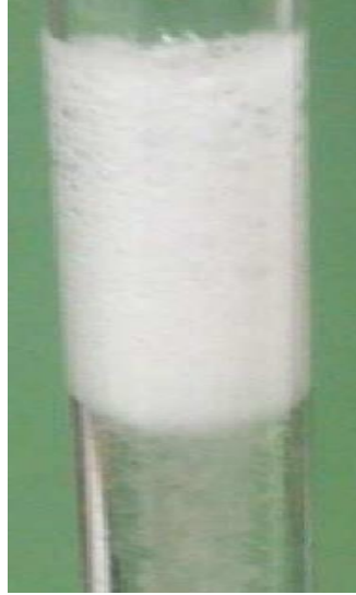
Şekil 4.17 : Mannich reaksiyon sonucu oluşan kuarternize selülozda köpük oluşumu
