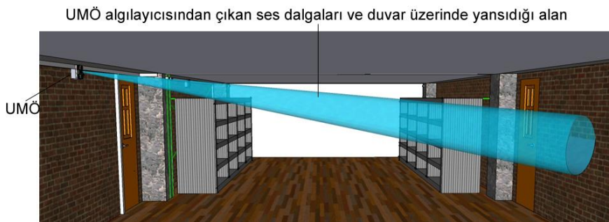
Şekil 3.4 : UMÖ'nün dolgu duvarı denetlemesi için yerleştirilmesi.
