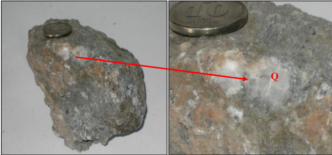
 ekil 3.6 : Eskiki la B lgesi cevherle meleri, t f konta ı yan kaya  numunesi i erisindeki bo luklarda g zlenen kuvars (Q) olu umları.
