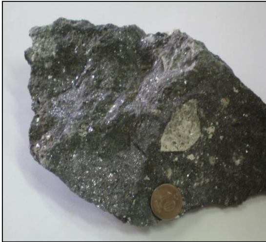
Şekil 3.8 : Eskikışla Bölgesi'nden alınan tüflerin breş dolgusu olarak görüldüğü cevher örneği.
