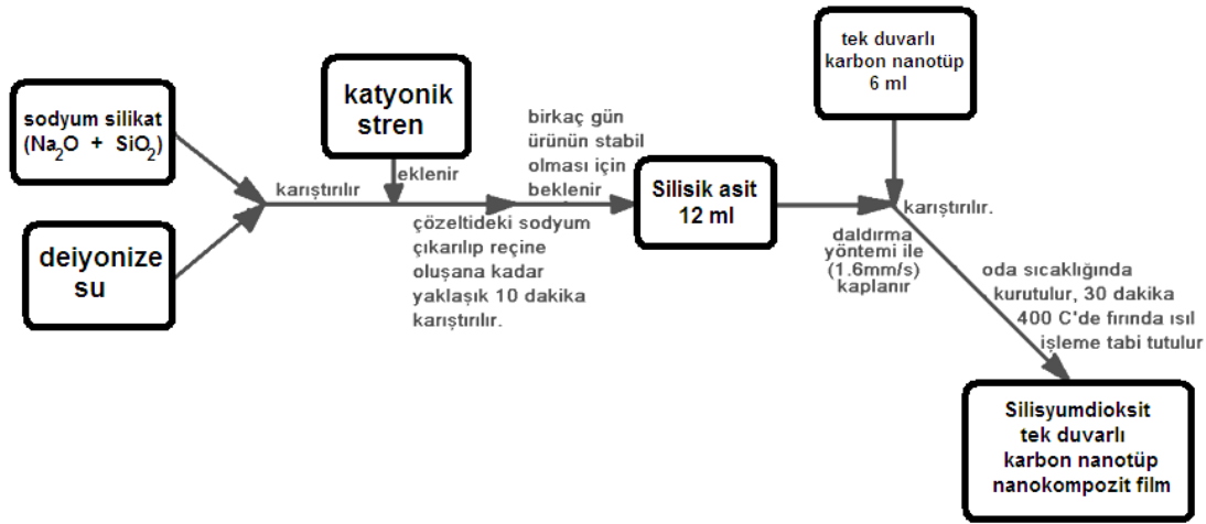
Şekil 4.10 : Silisyumdioksit nanotüplerin karbon nanotüpler kullanılarak eldesi.
